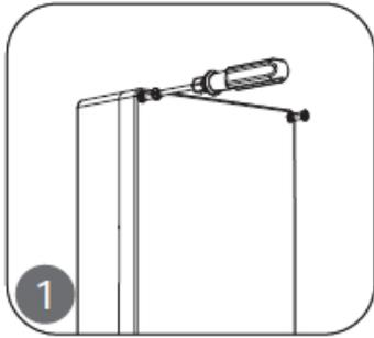
Dévisser les vis des 4 coins et démonter le couvercle du boîtier.
