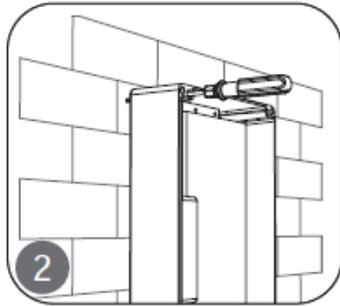
Fixer le produit dans la position spécifiée à l'aide des vis de l'armature.
