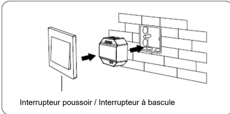
Soutenir la boîte de jonction debout de la manière suivante. La profondeur de la boîte de jonction est supérieure à 50 mm.
